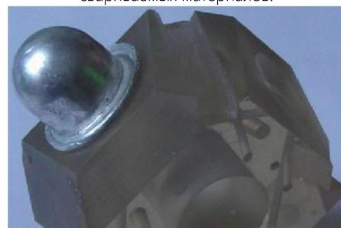
*A*-катод 285-3 приваренный к блоку лазерного гироскопа.
