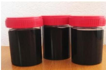
Эпоксидная-диановая смола ЭД-22, модифицированная углеродными нанотрубками
