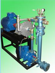
Технологический комплекс предназначен для предкрекинговой обработки нефти, улучшения качественных характеристик нефтепродуктов, создания устойчивых водотопливных микро- и наноэмульсий.
