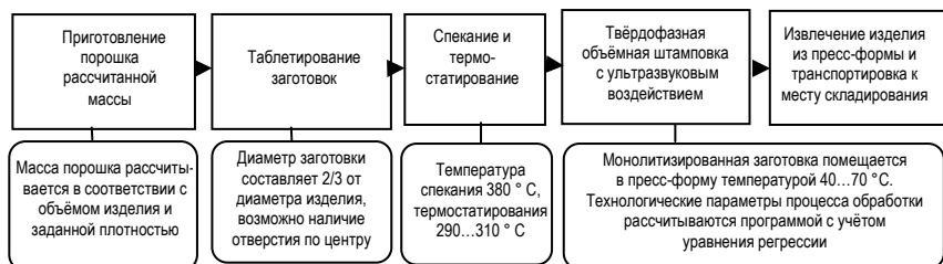
Рис. 4. Схема технологической линии твёрдофазной объёмной штамповки термопластов с ультразвуковым воздействием
