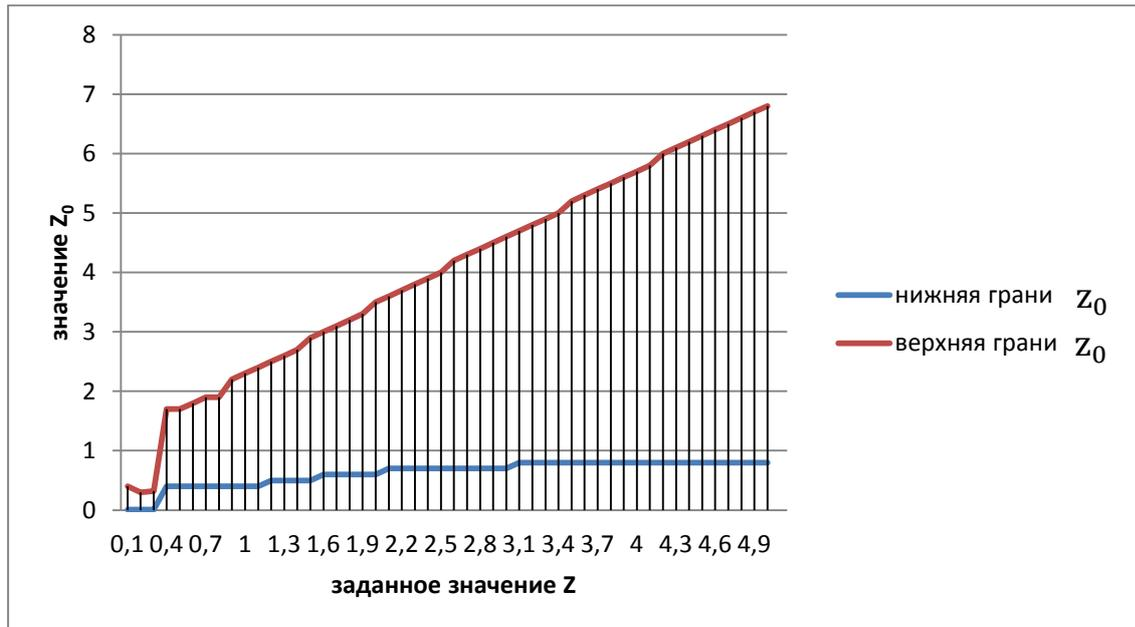
Рисунок 4.11 – Зависимость верхней и нижней границы начального значения  $z_0$  от заданного значения  $z$
