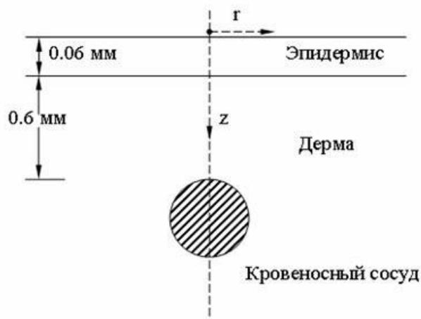
Рисунок 1.7 - Модель, учитывающая расположение кровеносного сосуда в подкожных тканях
